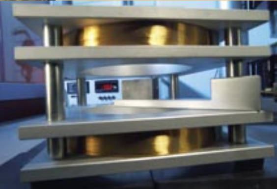
Die Helmholtzspule wird zusammen mit einem Fluxmeter gebraucht und ist bestimmt für die genaue und schnelle Messung verschiedener Formate und komplexer Formen magnetisierter SmCo-, Neoflux®- und Ferritmagneten.
