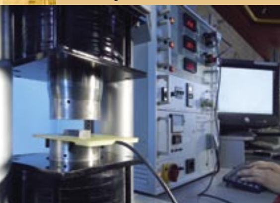
Der Permagraph kontrolliert, ob die Magneten den gegebenen Magnetspezifikationen entsprechen, eventuell bis zu einer Höchsttemperatur von 200 °C!
